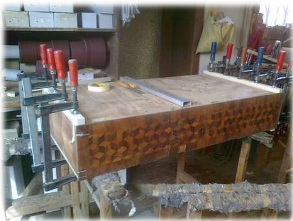
lockere Konstruktion der Laden verleimen
